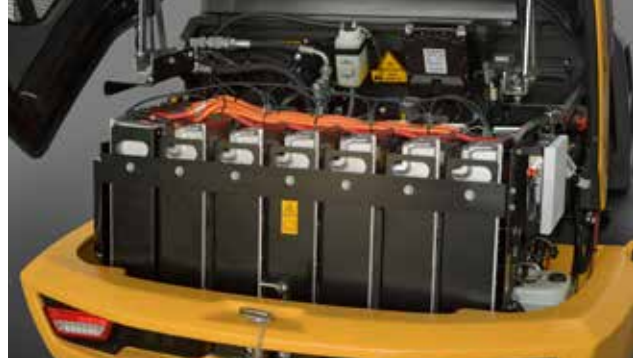
Scelta tra pacco batterie da 33 kWh o 40 kWh (L20 Electric)
